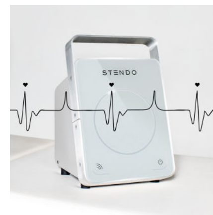
STENDO® V4: Das Steuergerät löst die kardial-synchronen Impulse aufgrund der Herzfrequenz aus, welche über einen Pulsoximeter gemessen und an die Manschette weitergeleitet werden.
