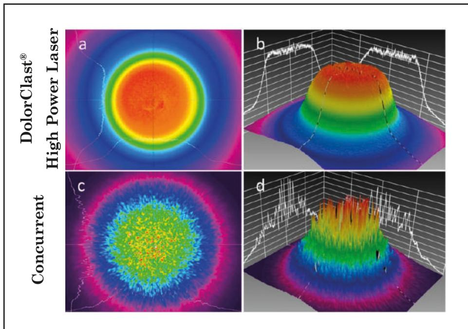
Cartes de densité de puissance enregistrées à l'aide d'une caméra de profilage de faisceau.<sup>29</sup>
